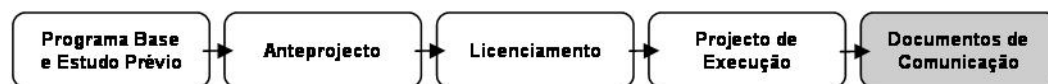
Fig. 30 – Localização da fase “Documentos de Comunicação” no processo construtivo, etapa “Estudos e projectos”
