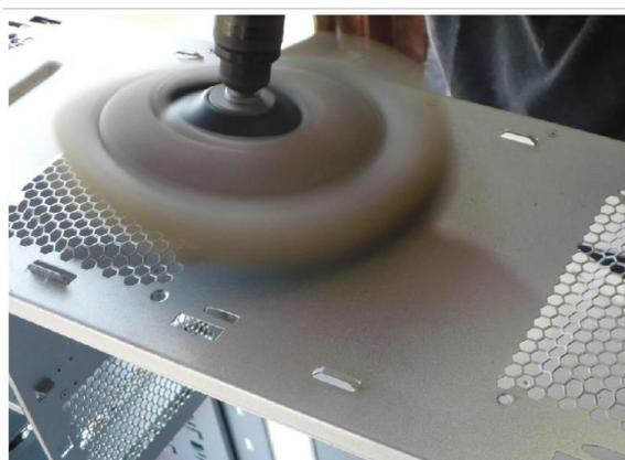
Figura 3.12 - Lixagem de estrutura metálica.
