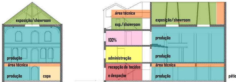
Fig. 74 – Corte Transversal e Longitudinal - Proposta funcional da Arquitectura, ao programa, nos 4 pisos
