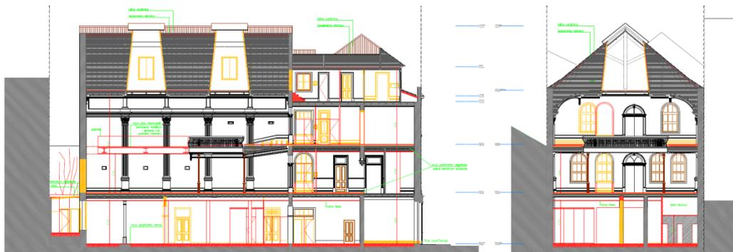
Fig. 81 - Corte longitudinal (esquerda) e transversal (direita) - vermelho (construção nova), amarelo (demolições)
