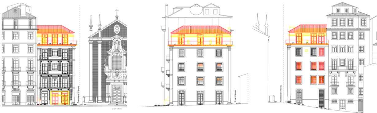
Fig. 29 - Indicação das alterações e dos trabalhos a realizar - Alçados (amarelo – demolições; vermelho – construção nova; preto – reabilitação; cinzento – edifícios vizinhos)
