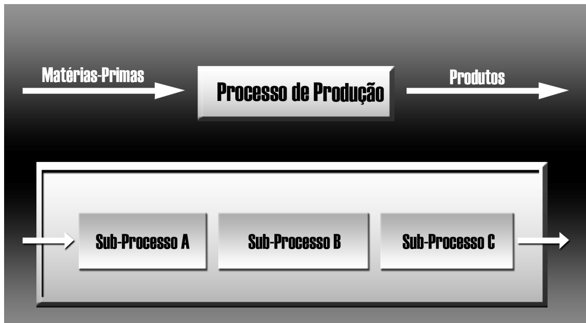
Figura 4.2 – Modelo tradicional de processo (adaptado, Koskela, 1992)
