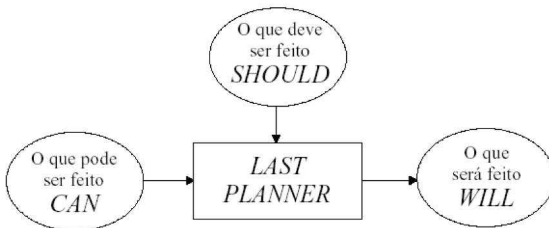
Figura 5.1 – Processo de Planeamento Last Planner (Ballard e Howell, 1997)
