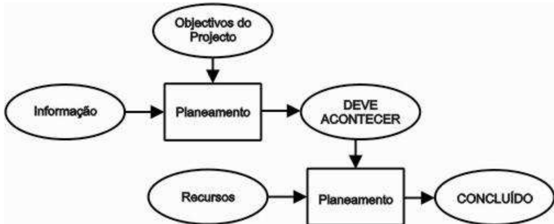
Figura 5.3 – Processo Tradicional de Planeamento (Ballard e Howell, 1994)
