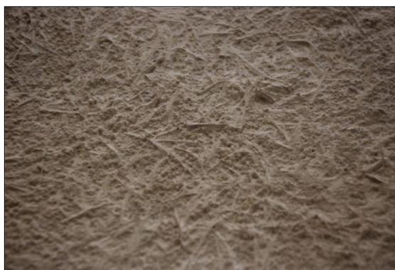
Figura 28 – Betão reforçado com fibras de vidro [155]
