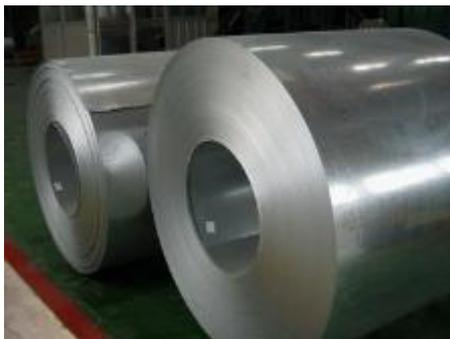
Figura 46 – Bobinas de aço galvanizado por imersão a quente [151]
