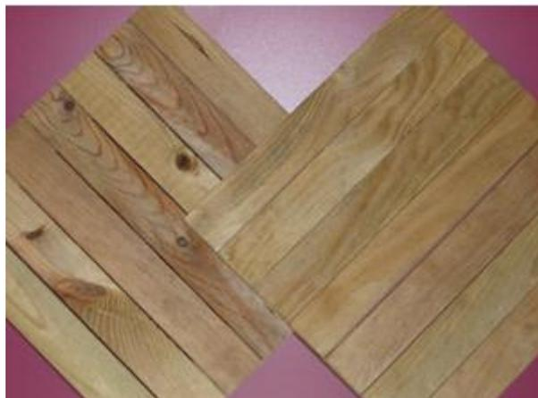
Figura 35 – Excerto de pavimento em madeira por impregnação química em autoclave [142]
