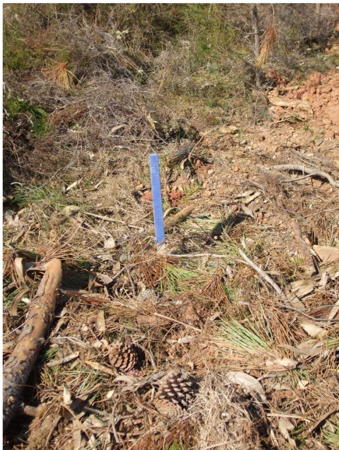
Figura 15 - Fotografia referente a estaca de expropriação.
