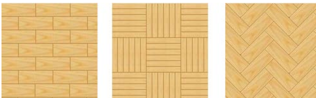
Fig.7.11 – Pavimento colocado a Mata-Juntas, Xadrez e Espinha [37]
