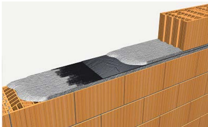
Fig.7.62 – Impermeabilização do pano interior das paredes exteriores [37]
