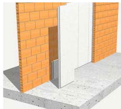
Fig.7.55 – Exemplo de poliestireno expandido [55] e [37]
