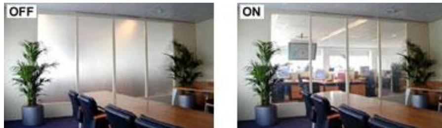
Figura 16 - Controlo da opacidade com sgg Priva-Lite<sup>®</sup> da Saint-Gobain. Sem passagem de corrente é opaco, com a passagem de corrente torna-se transparente.
