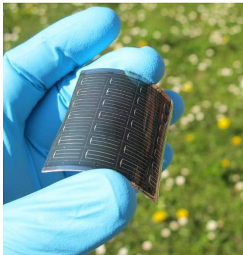
Figura 20 – Célula Solar flexível CIGS. Site da Empa.
