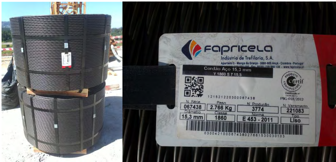
Figura 63 - Cabos de pré-esforço
