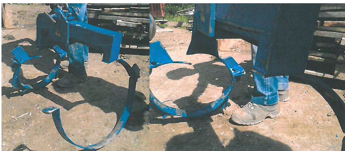
Figura 86 – Balança do macaco hidráulico após o incidente
