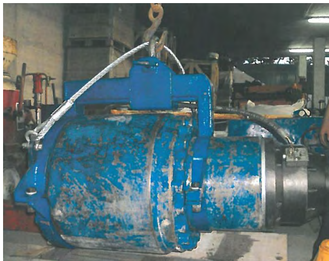
Figura 87 – Macaco hidráulico munido de balança e cabo de aço
