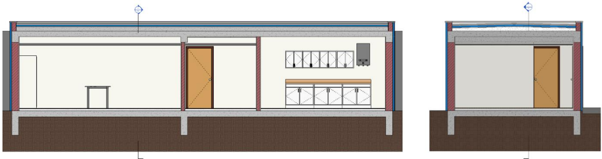
Figura 42 – Cortes gerados automaticamente em Revit.
