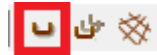
Figura 45 – Ícone referente à criação de uma barra de armadura ( software Tekla Structures)
