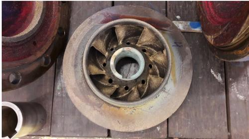
Vista do impulsor nº 4 após a desmontagem. Este impulsor foi substituído.
