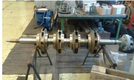
Vista do conjunto rotórico, com 2 impulsores novos e 2 recuperados, após verificação dimensional e retificação efetuadas na Oficina de Tornearia.
