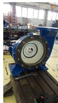
Vista da voluta após decapagem e revestimento
