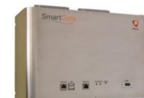
DTC instalados em todos os Postos de Transformação
