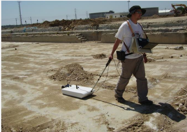
Figura 3 - Ensaio geofísicos pelo método das ondas superficiais
