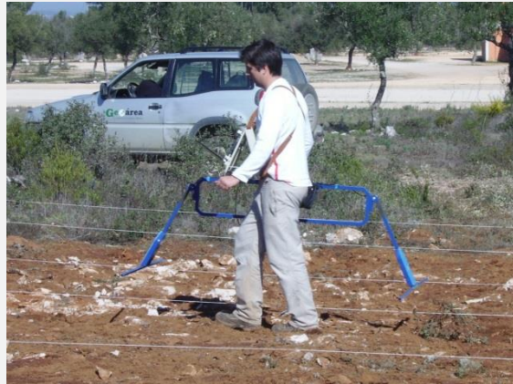
Figura 3 - Ensaio geofísicos pelo método das ondas superficiais
