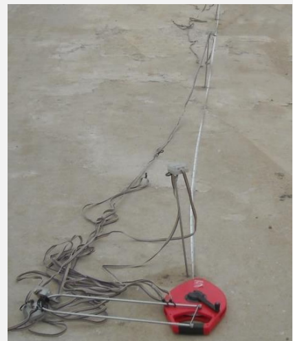
Figura 2 - Ensaios geofísicos por resistividade elétrica. Perfil de resistividade e equipamento
