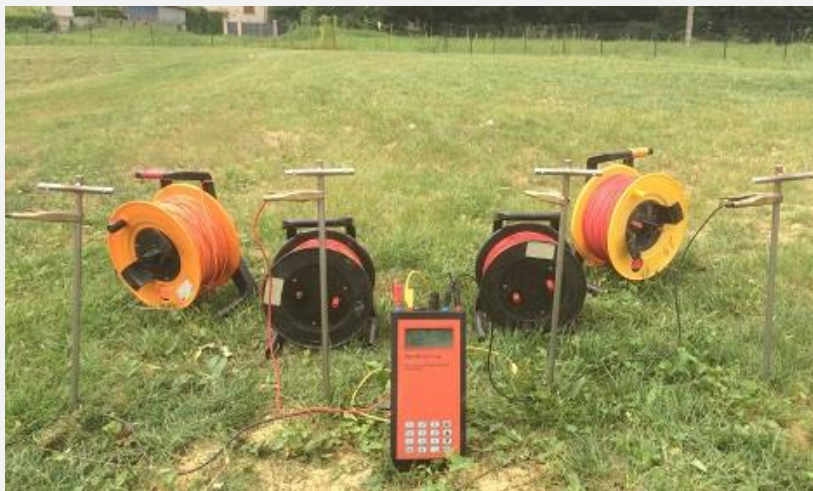
Figura 2 - Ensaios geofísicos por resistividade elétrica. Perfil de resistividade e equipamento
