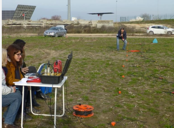
Figura 3 - Ensaio geofísicos pelo método das ondas superficiais
