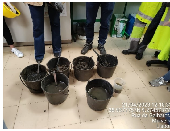
Verificação do teor de sólidos em cada fase da desidratação do digerido da digestão anaeróbia
