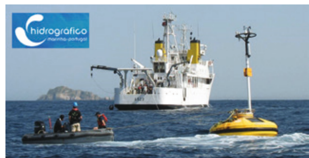
Figura 2 Boia oceanográfica multiparamétrica da rede de monitorização ambiental a ser fundeada ao largo das Berlengas, com o navio hidrográfico NRP "Almirante Gago Coutinho"
