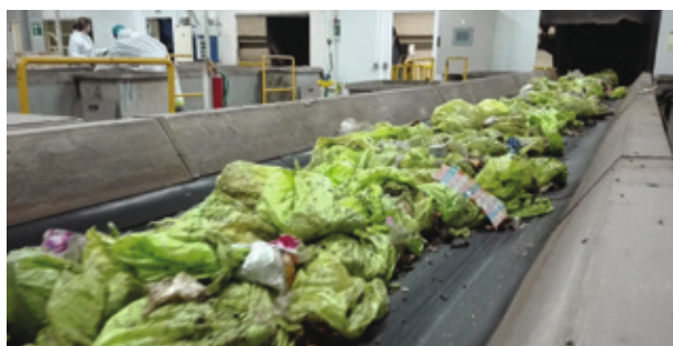
Sacos de biorresíduos separados no sistema ótico a serem encaminhados para o abre sacos da unidade de digestão anaeróbia
